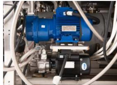
Вакуумный насос для более эффективного и быстрого создания вакуума.
