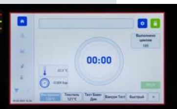
**1 уровень:** доступ к обычным операциям стерилизаторов: включить / выключить, запустить циклы, сбросить некритические аварийные сигналы и открыть двери.
