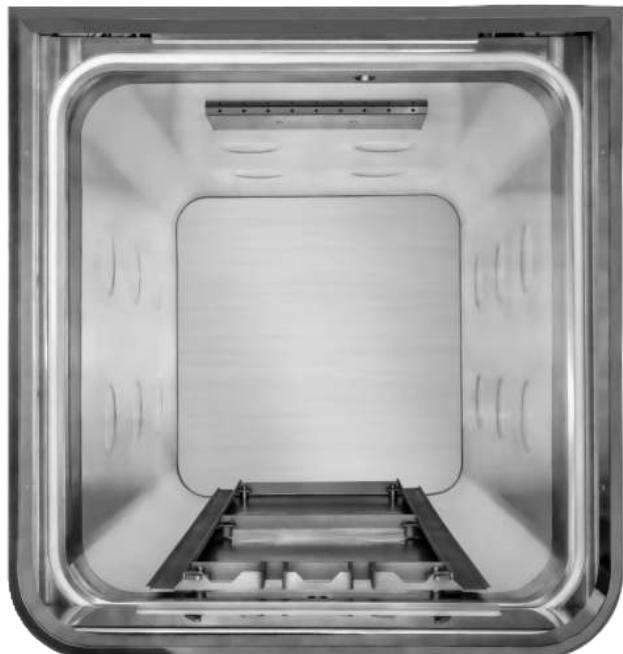
Камера квадратного сечения имеет полезный объем на 30% больше по сравнению с камерой круглого сечения.
